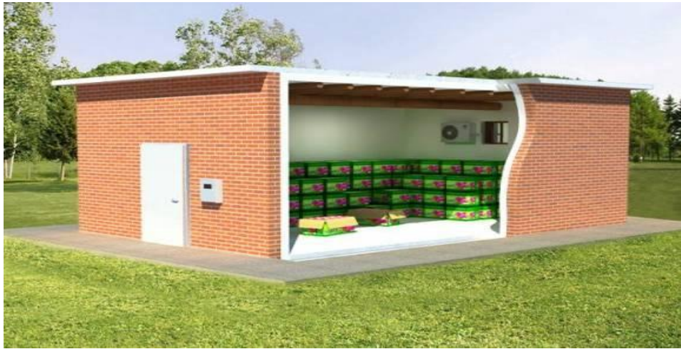
图 2-3 土建式高温冷藏库示意图
